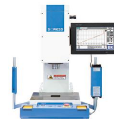
轴承铆钉 - 铆钉设备 脱离力: MIN 160 Kgf
