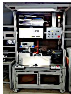
用于检测装配和尺寸的视觉检查设备。
